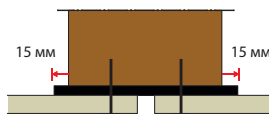
Деревянная подконструкция, решение для вертикальных стыков с прокладкой в виде ленты EPDM
